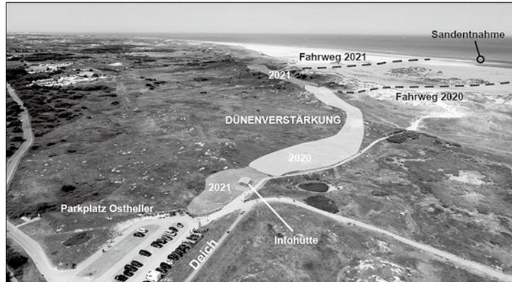
Auf der Fläche nördlich des Parkplatzes Ostheller wird in den kommenden Wochen sowie 2021 70.000 Kubikmeter Sand eingebaut werden. Foto: NLWKN
